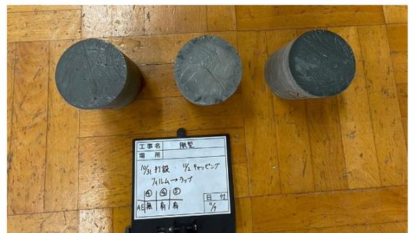
図6 キャッピングで食品用ラップを使用したもの
