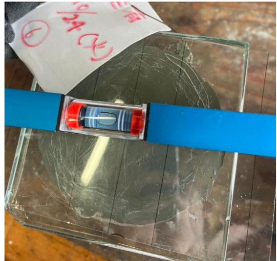
図5 水平器にて水平度合いを確認した様子
